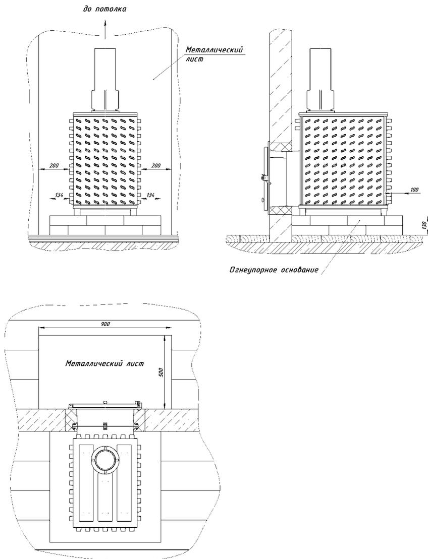
**Рис.3 – Монтаж печи**
