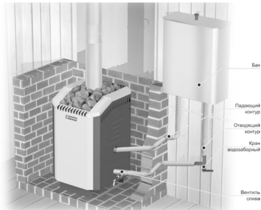
Уклон подающего и отводящего контура не менее 20° в направлении от бака к печи Рисунок - 8 Схема установки выносного бака в парилке.
